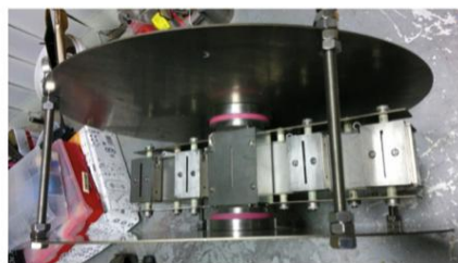
Рис. 1. Масс-анализатор ионного состава плазмы (система зондов Ленгмюра не показана):
