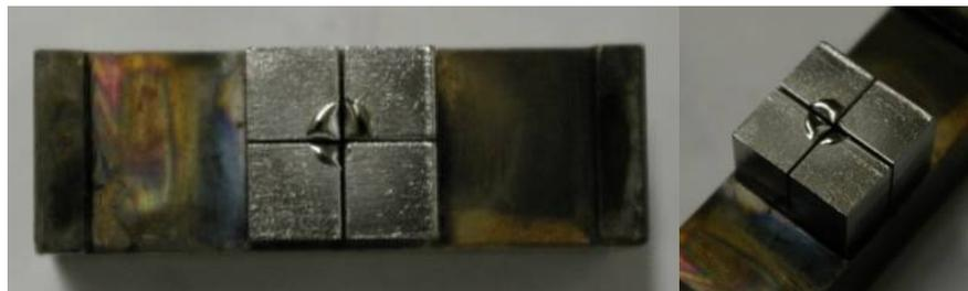
*Рис. 1. Внешний вид вольфрамового образца после термоциклирования*
