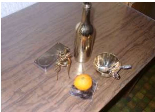
Рис. 25. Покрытые нитридом титана на нашей кафедре различные бытовые изделия (в группе Леона Богдановича). Конечно, установки были намного
