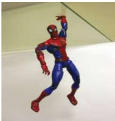
Рис.32. «Липучка»: а) структура, выращенная с помощью плазменной технологии и перенесенная на гибкую основу, б) ладонь игрушки, на которую нанесен этот «материал» выдерживает вес в 400\text{г/см}^2
