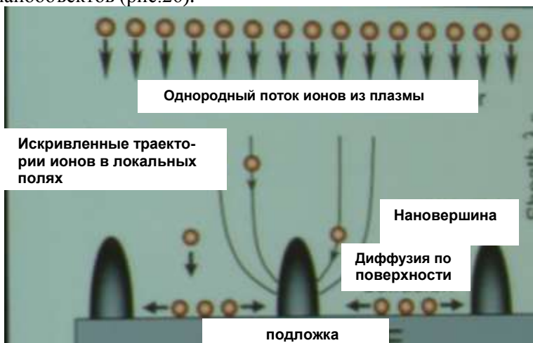
Рис.26. Процесс самоорганизации наноструктуры на поверхности под действием плазменного облучения (материал любезно предоставлен Костей Остриковым)
