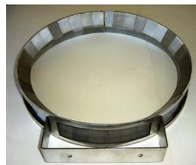
Рис. 6. Кольцевая диафрагма токамака Т-11М
