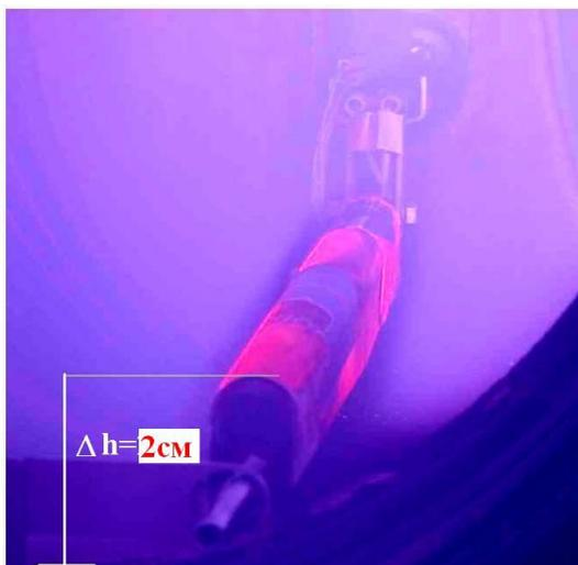
Рис. 2. Положение продольного литиевого лимитера в камере T-11M
