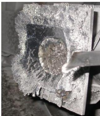
Рис. 1. Бериллиевая пластина толщиной 5 мм после 70 импульсов КСПУ,  $Q = 0.5$  МДж/м<sup>2</sup>,  $\tau = 0.5$  мс
