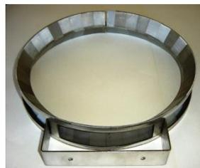
Рис. 6. Кольцевая диафрагма токамака Т-11М
