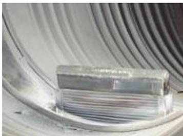
Рис. 3. Горизонтальный рельсовый литиевый лимитер в камере токамака Т-11М
