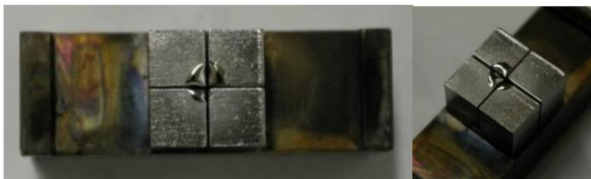
Рис. 2 Внешний вид вольфрамового образца после термоциклирования
