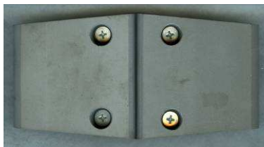
Рис. 1. а) Мишень из двух моноблоков графита МПГ-8 с покрытием B_4C , б) Пористый верхний слой покрытия B_4C
