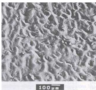
Рис. 1. Структура поверхности ванадиевого сплава после облучения 5-ю импульсами дейтериевой плазмы в плазменном ускорителе МК-200 ( 2 \cdot 10^{10} Вт/м 2 , 50 мкс) [2]
