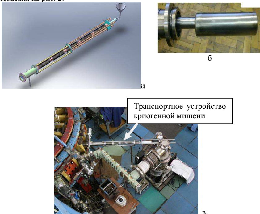
Рис. 2. Криогенная мишень: а – общий вид, б – приёмная часть мишени, в – Т-11М и транспортное устройство мишени (вид сверху)
