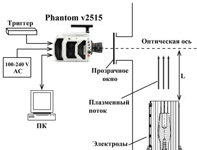
Высокоскоростная съемка позволила определить, что плазменный поток длительностью в среднем 500 мкс
