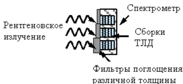
Рис. 1 Малогабаритный спектрометр рентгеновского излучения плазмы.
