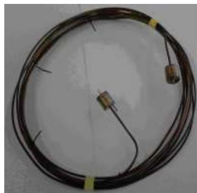
Экспериментальный образец кабеля с минеральной изоляцией (длина - 12,4м), с разделанными (герметизированными) концами.
