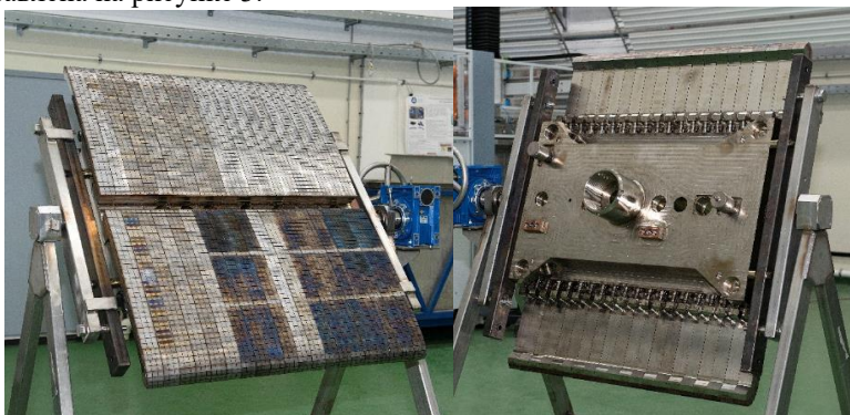
Рисунок 3 – Изготовленный полномасштабный прототип ППС ИТЭР
