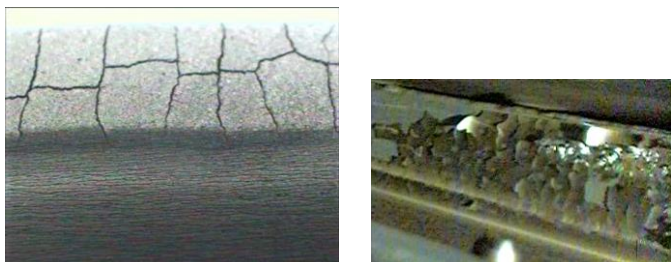
Рисунок 3 – Графитовая пластина полоидальной диафрагмы на внутреннем обводе в токамаке T-10 после экспериментальной кампании: (а) растрескивание, эрозия и дуговые трэки, (б) осаждённые углеводородные плёнки
