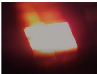
Рисунок 5 – Изображение поверхности охлаждаемого вольфрамового макета при стационарном режиме нагрева электронным пучком
