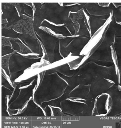
Рисунок 1 – Поверхность пиролитического графита ПГВ после одного цикла облучения
