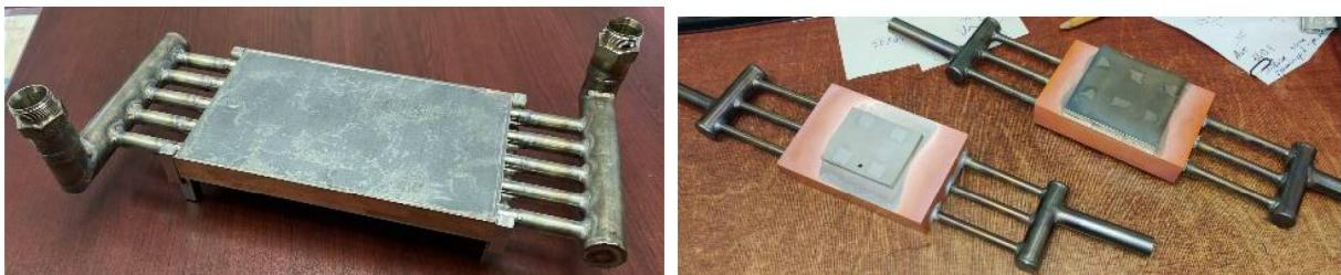
Рисунок 4 - Биметаллические ГИП, CVD и МВП пластины на охлаждаемых медных подложках для тепловых испытаний
