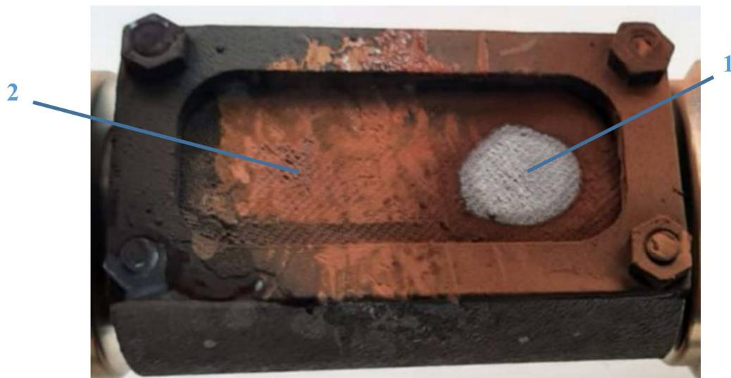
Рисунок 2. – Фотография обращенной к плазме поверхности макета литиевой ЖМ КПС после испытаний в установке ПЛМ, 1 - область с литием, 2 - область лазерных нагрузок
