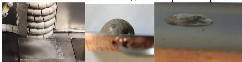
Рисунок 1 Устройство для исследования смачиваемости и вид капли лития после выдержки при температуре  $340^{\circ}\text{C}$  и  $600^{\circ}\text{C}$
