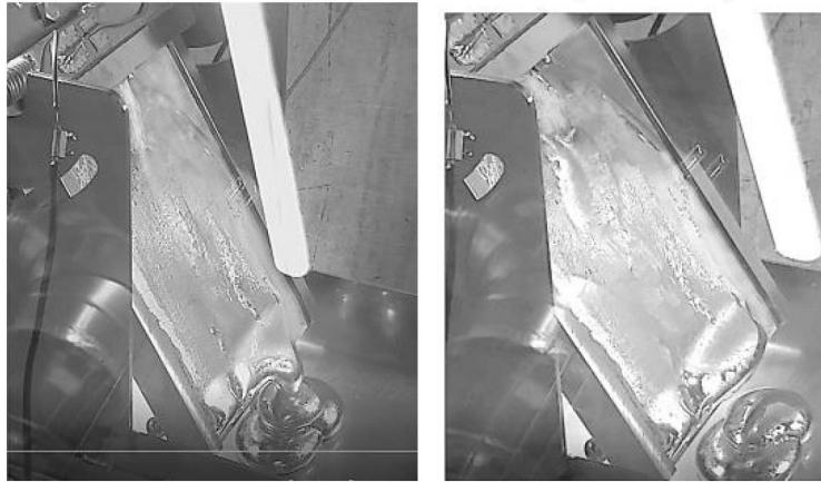
Рисунок 3 - Течение лития при расходе 0.2 г/с и 0.8 г/с
