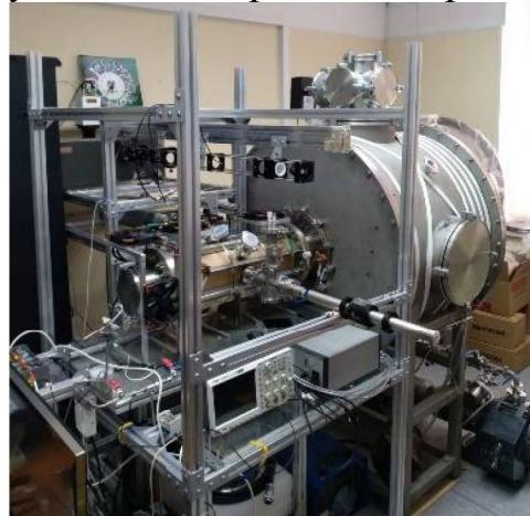
Рис. 1. Фото установки ПЛМ-М с лазерным комплексом
