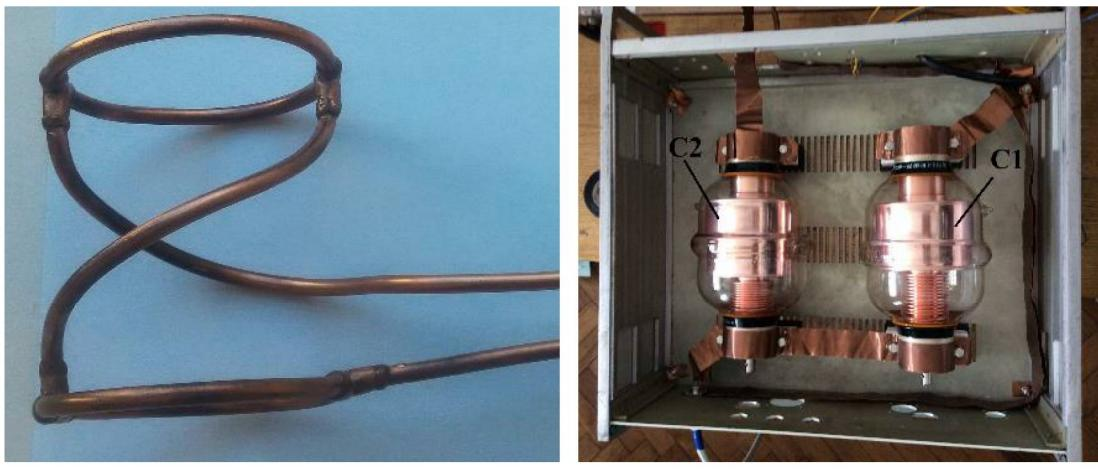
Рисунок 2 – (а) Фотография изготовленной геликонной антенны;
