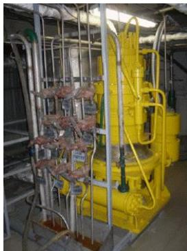
Рисунок 3. Стенды для исследования теплообмена в конструктивных компонентах и гидродинамики теплоносителя при высоком давлении.
