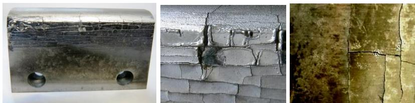
Рис.1 Вид обращенных к плазме сторон пластин 01e и 01i
