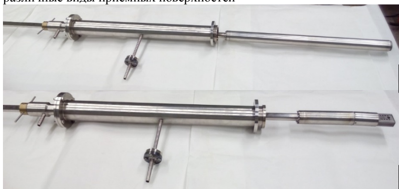
Рис. 2 Устройство для сбора лития токамака Т-10: а – в форме гладкого цилиндра, б – в форме диагностического зонда
