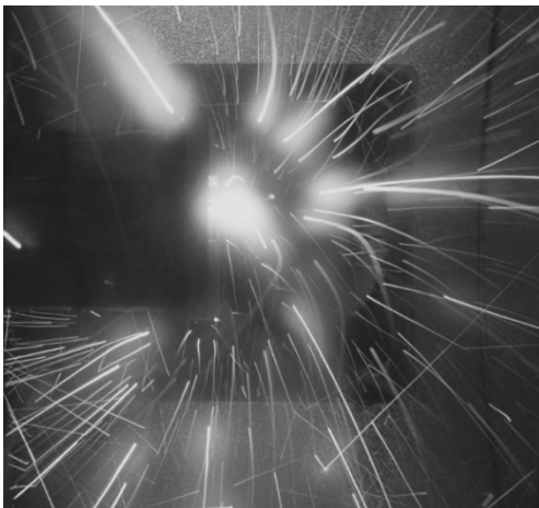
Рис. 2. Треки капель, инжестируемых с вольфрамовой мишени. Поток водородной плазмы падает на мишень справа.
