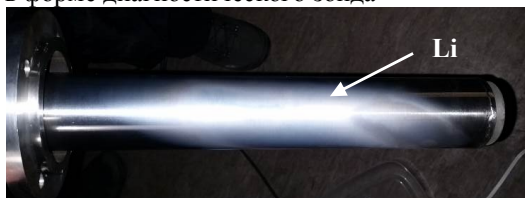
Рис. 3. Вид литиевой мишени после эксперимента в токамаке Т-10
