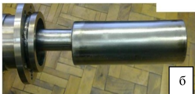
Рис. 1. Устройство для сбора лития токамака Т-11М. а – общий вид, б, в – различные виды приёмных поверхностей
