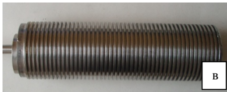
Рис. 1. Устройство для сбора лития токамака Т-11М. а – общий вид, б, в – различные виды приёмных поверхностей
