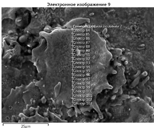
Рис. 1. Застывший расплав поверхности электрода.
