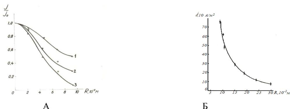
Рис.2 А- пространственное распределение плотности ионного тока в эродированном потоке стали на расстояниях 1 -15см, 2-19см 3- 23см от плоскости катода, ток разряда 150А; Б- зависимость плотности ионного тока в эродированном потоке стали от расстояния до плоскости катода вдоль его оси, ток разряда 150 А.
