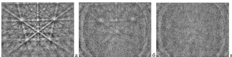
Рис. 2. Экспериментальные ДОЭ-картины: а) исходного *c*-Si; и PSi сформированного имплантацией *c*-Si ионами  $\text{Ag}^+$  с энергией 30 кэВ при дозе облучения  $1.5 \cdot 10^{17}$  ион/ $\text{см}^2$  и плотности тока в ионном пучке: б) 2; в) 8  $\text{мкА/см}^2$ .
