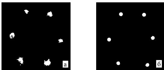
Рис.2. Картины ДМЭ, снятые: после очистки Si(111) термическим прогревом в два этапа – а; после термического прогрева при  $T=1500\text{К}$  Si(111), имплантированного ионами  $\text{Ba}^+$  с энергией  $E_0=1\text{кэВ}$  и дозой облучения  $D=10^{17}\text{см}^{-2}$  –б.
