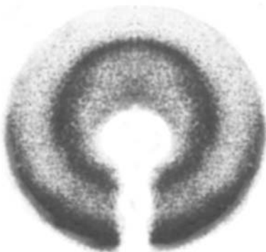
Рис. 3. Дифракционная картина от разупорядоченных кристалликов сразу после расслоения.
