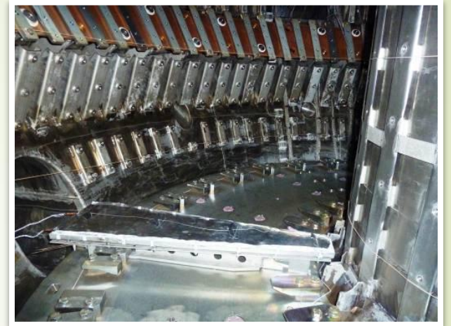
Модель охлаждаемого литиевого дивертора
