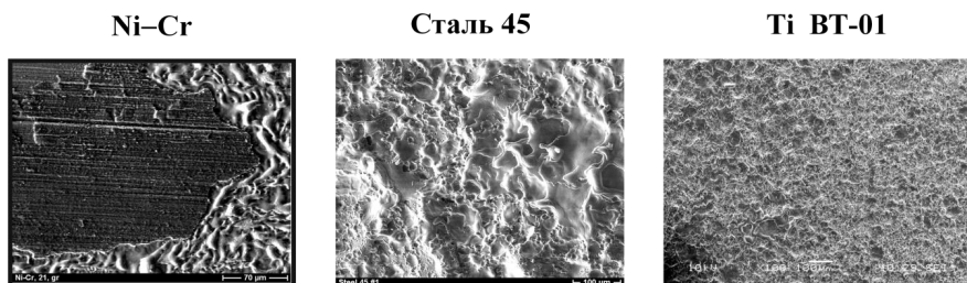
Рис. 17.12. Фотографии фрагментов образцов, полученные в растровом электронном микроскопе. Характерный вид микрорельефа, сформированный в микроплазменных разрядах на поверхности никелево-хромистого сплава (NiCr), конструкционной стали 45, титанового сплава VT-01. На фотографии NiCr часть поверхности слева без микрорельефа – это необработанная часть поверхности с оксидной пленкой толщиной 1 мкм. Размер изображений по горизонтали около 300 мкм.
