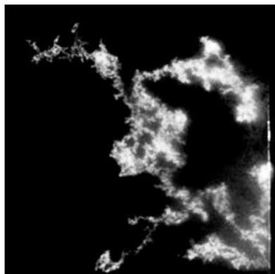
Рис. 12.2 Свечение микроплазменного разряда на поверхности пластины из титана, покрытой оксидной пленкой толщиной 2-6 нм. Разряд инициируется потоком внешней плазмы ( 2 \cdot 10^{13} \text{ см}^{-3} ) справа и далее поддерживается в течение 1-2 мс источником импульсного электрического тока 50 А. Размер изображения 17.5 \times 17.5 \text{ мм}^2 .
