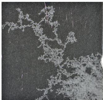
Рис. 17.9 Фотография фрагмента поверхности пластины из титана с естественной оксидной пленкой толщиной около 6 нм с поверхностной эрозией в виде дендрита, возникшей в результате 2 импульсов микроплазменных разрядов с длительностью 1.6 мс с током 200А. Размер изображения 10×10 мм
