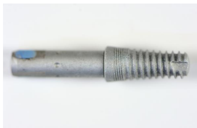
Рис. 17.8 Микроплазменные разряды на поверхности стоматологических имплантатов формируют прочный микро рельеф для увеличения площади контакта с костной тканью. Длина имплантата 25 мм. Слева сверху - фото исходного образца, справа сверху – разряды на поверхности образца, внизу слева – образец со сплошным микро рельефом на поверхности
