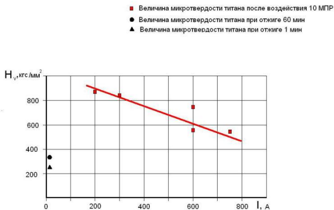
Рис. 17.21 Величина микротвердости образцов титана, подвергнутых воздействию 10 импульсов микроплазменных разрядов (МПП) с амплитудами токов в интервале значений 200 А-750 А при длительности импульса 20 мс (красные квадраты) в сравнении с образцами титана без микроплазменной обработки, но прошедшими температурный отжиг при температуре 400°C (черный треугольник - образцы без отжига, или при коротком отжиге в течение 1 мин., черный кружок - при отжиге в течение 60 мин.)
