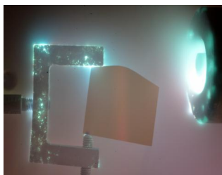
Рис. 17. 5. Фотография, подтверждающая отсутствие возбуждения микроплазменных разрядов на поверхности образца из золота (99,99%) без диэлектрических пленок при воздействии потока плазмы с плотностью 5 \cdot 10^{13} \text{ см}^{-3} и длительностью 25 мкс. Поток плотной плазмы возбуждает микроплазменные разряды на поверхности держателя образца из нержавеющей стали, несмотря на то, что он прошел предварительную очистку разрядами в результате воздействия около 10^3 импульсов плазмы плотностью 2 \cdot 10^{13} \text{ см}^{-3} .
