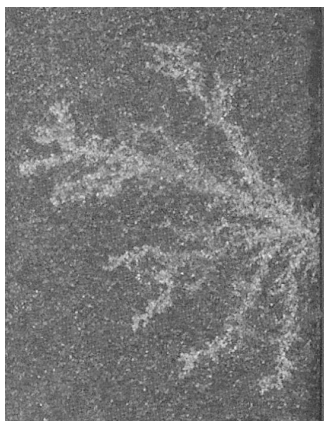
Рис. 13.6 Макрофотография зоны эрозии на поверхности пластины из титана, покрытой оксидной пленкой толщиной 10 нм, в результате возбуждения одиночного микроплазменного разряда с длительностью 100 мкс и амплитудой электрического тока 200 А. Размер изображения 7 \times 8.6 \text{ мм}^2 .
