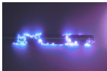
Рис. 17.3 Фотография свечения моноимпульсного микроплазменного разряда, возбужденного потоком плазмы плотностью 10^{13} \text{ см}^{-3} на поверхности титанового цилиндра диаметром 4 мм и длиной 5 см с естественной оксидной пленкой толщиной около 6 нм. Поток плазмы падает справа. Длительность разряда 1.6 мс, амплитуда импульсного тока 50 А. Размер свечения по горизонтали 30 мм. Скорость распространения МПР составляет V \approx 16 \text{ м/с} .
