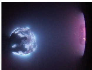
Рис. 17.4 Фотография микроплазменных разрядов, возбуждаемых на образце (слева) из кобальто-хромистого сплава со сложной структурой поверхности, частично покрытой диэлектрической окисной пленкой. Справа - торец плазменного инжектора диаметром 30мм.
