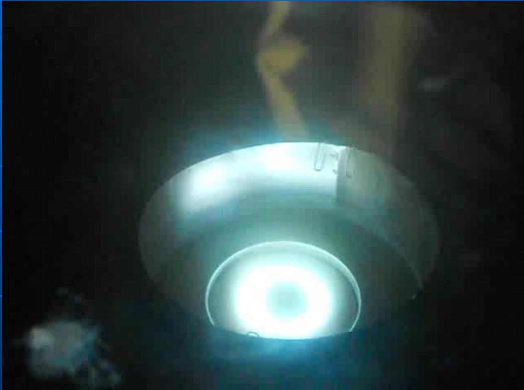
Новый магнетрон на кафедре 21 с жидким катодом = рекордные скорости нанесения покрытий
