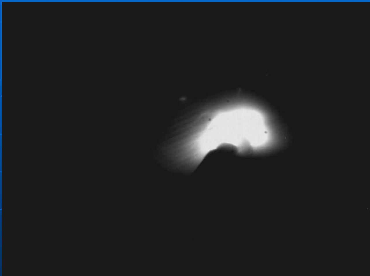
разрешение - 640 × 480 точек; частота – 249 Гц; экспозиция – 4 мс; оптический фильтр на линию LiI (670,8 нм); схема сохранения данных – разр. 2-9 АЦП-10;
