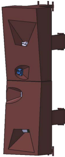
Рис. 25.16. Элемент «диагностической первой стенки»
