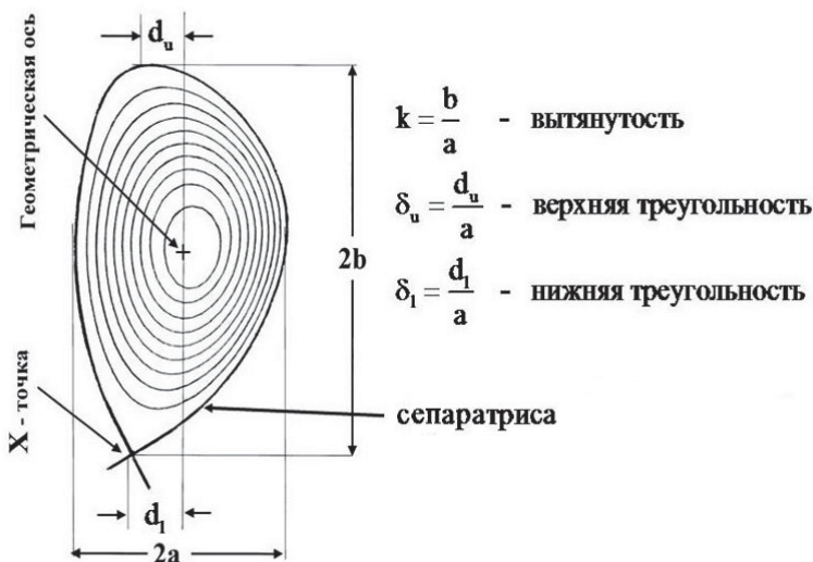
Рис. 9.9. Топология вытянутого сечения
