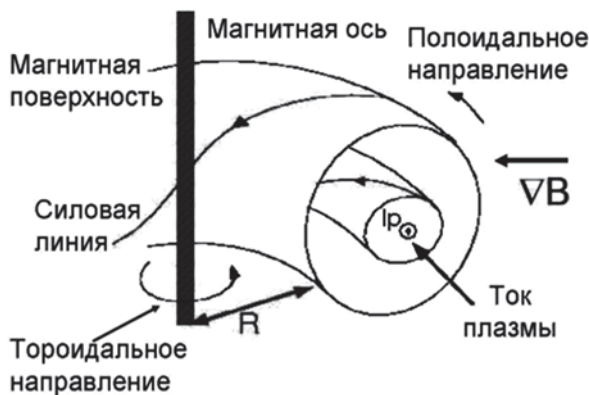
Рис. 9.1. Топология силовых линий магнитного поля в токамаке с круговыми магнитными поверхностями
