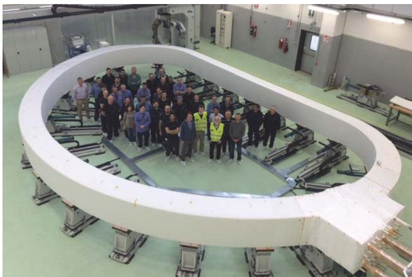
Рис. 25.5. Собранная и испытанная обмотка катушки тороидального поля (Европа)
