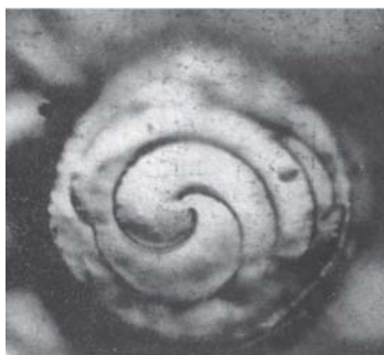
Рис. 13.3. Пример винтовой дислокации
