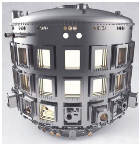
Рис. 25.10. Криостат (высота – 29 м, диаметр – 29,4 м)
