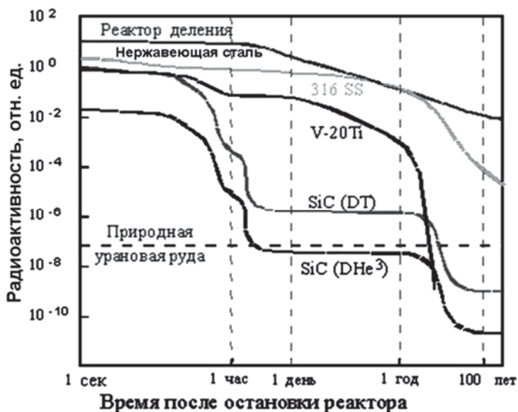
Рис. 17.1. Активация некоторых материалов в процессе работы реактора
