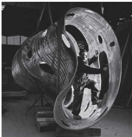
Рис. 8.6. Часть вакуумной камеры современного стелларатора
