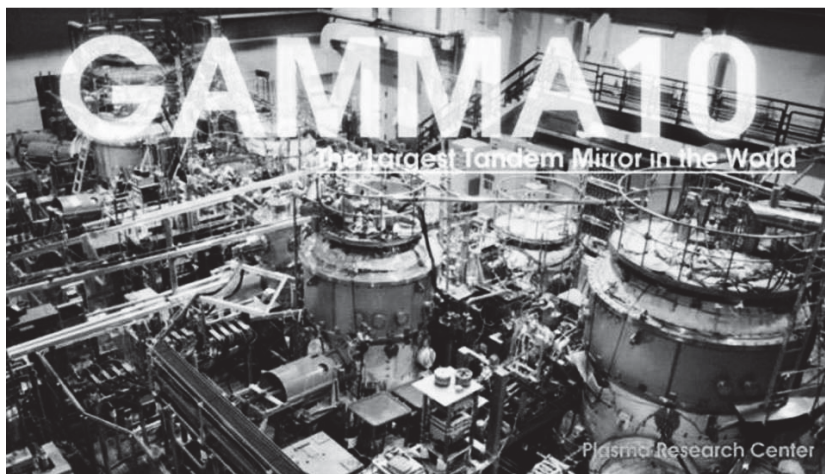
Рис. 7.9. Амбиполярная ловушка «Гамма-10» (Япония)
