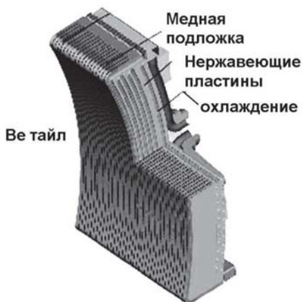
Рис. 15.4. Устройство бланкета ИТЭР
