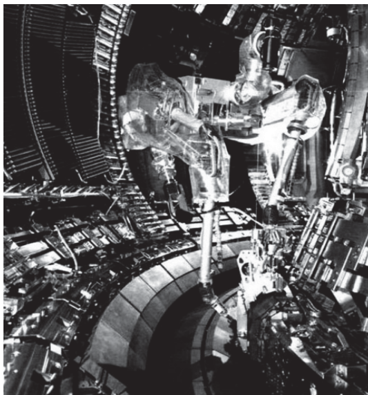
Рис. 17.2. Манипулятор установки JET
