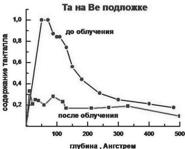
Рис. 13.9. Распределение Ta, нанесённого на W, в приповерхностном слое до и после облучения
