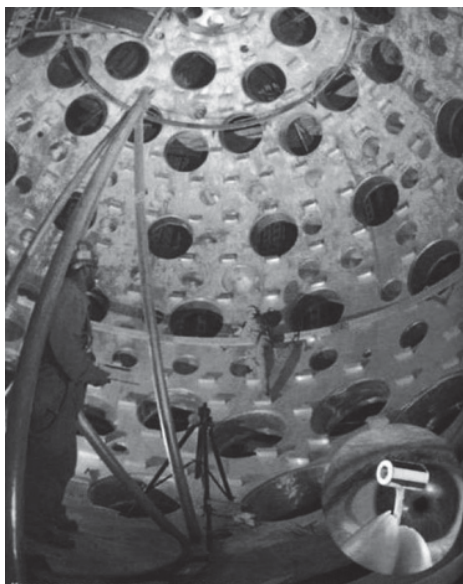
Рис. 12.4. Фотография камеры NIF во время монтажа. На врезке – золотая мишень
