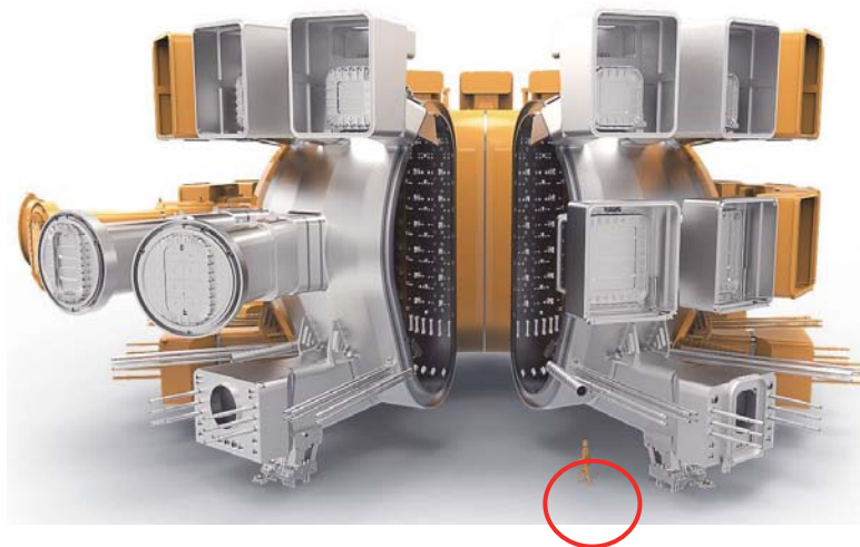
Рис. 25.9. Вакуумная камера в собранном виде
