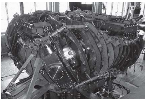
Рис. 8.7. Вакуумная камера стелларатора в сборе
