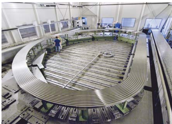
Рис. 25.3. Элемент радиальной пластины из нержавеющей стали для катушки тороидального поля для укладки сверхпроводящего кабеля (а) и её общий вид при изготовлении (б)
