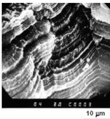
Рис. 13. Слоистая плёнка вдали от лимитера, режим – без перегрева лимитера
