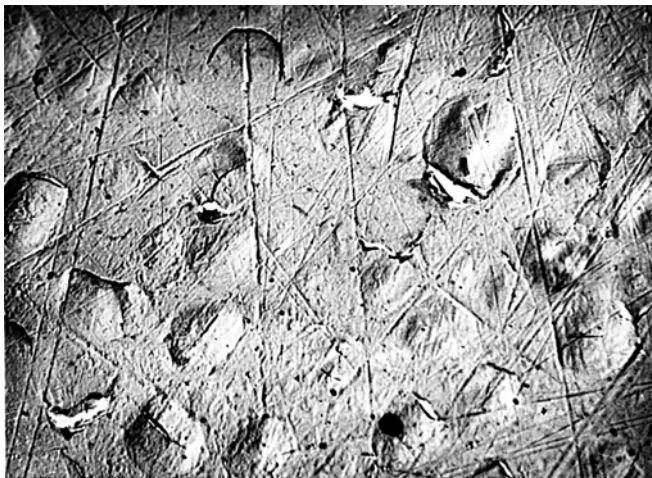
Рис. 3.4. Изгибание и опускание крышек блистеров (лейкосапфир, \text{H}_2^+ , E_i = 35 кэВ, \Phi = 1 \cdot 10^{18} ион/см 2 , T = 400 К)
