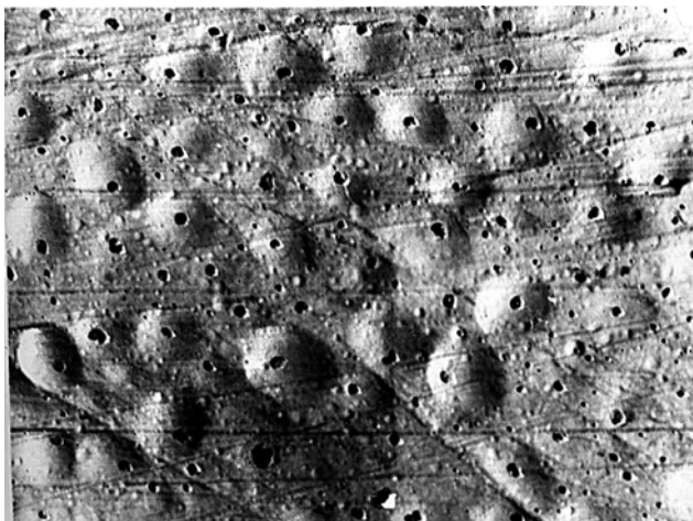
Рис. 3.2. «Маленькие блистеры» (лейкосапфир, \text{H}^+ , E_i = 10 \text{ кэВ} , \Phi = 1 \cdot 10^{18} \text{ ион/см}^2 , T = 400 \text{ К} )
