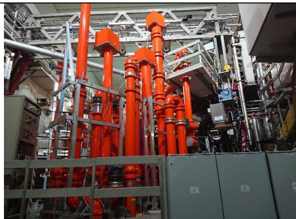
Зал с токамаком. Оранжевый цвет – гиротрон и каналы передачи излучения к антеннам в камеру. В верхнем правом углу – устройство для инъекции гранул с топливом (пеллет) в центр плазменного шнура
